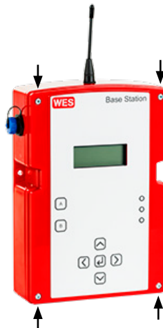
Fig. 2, position de départ du boîtier avec les vis. Indiquée en orange.
