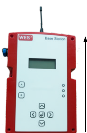
Fig. 1, faire coulisser la façade du boîtier du bas vers le haut. La flèche orange indique le sens de coulissement.
